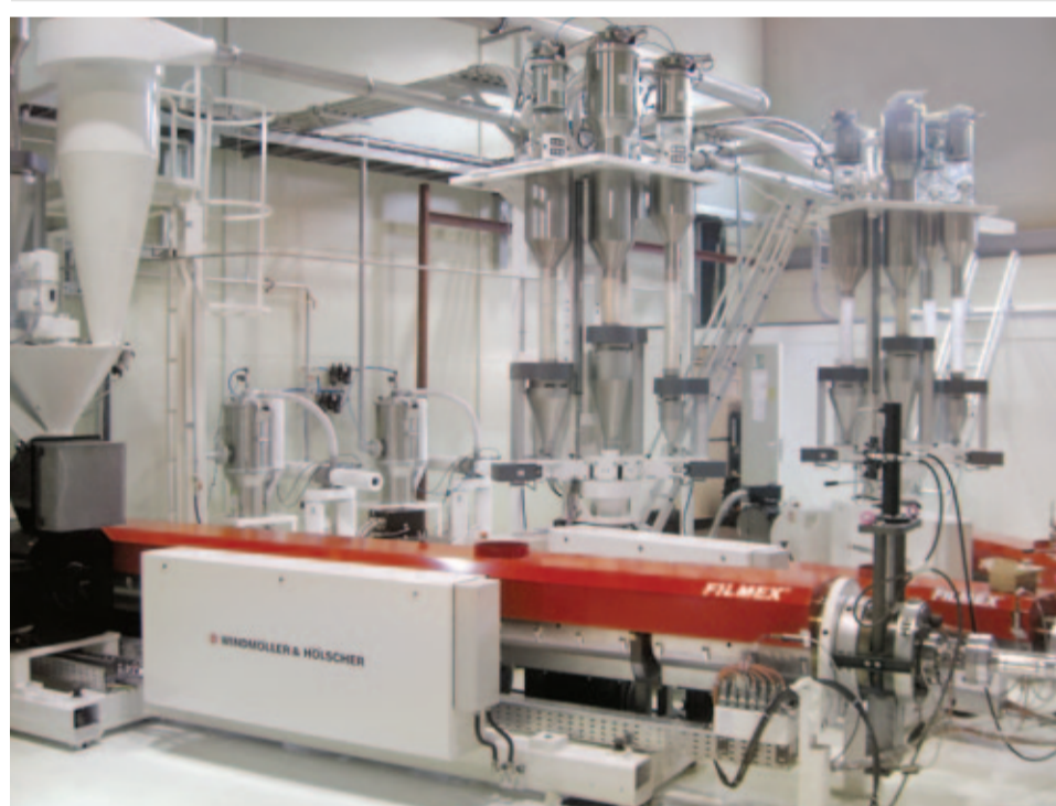
Тремя экструдерами оснащена FILMEX для выпуска пленок CPP и для защиты поверхностей на Sammin Chemical.
